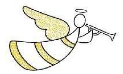
Fornecimento como locação de figura luminosa bidimensional com desenho em forma de Anjo com asa ornamentada com desenhos Art Nouveau, com 3,0m de altura x 1,30m de largura; com estrutura de barra chata de ferro de ¾",e contorno duplo de mangueira luminosa transparenteflexlight LED, blindada para uso externo, que permite a ampla iluminação nas peças, na cor Branco Morno 3000K; Preenchimento de ornamentos Art Nouveau na asa, com contorno de mangueira luminosa transparente flexlight.
