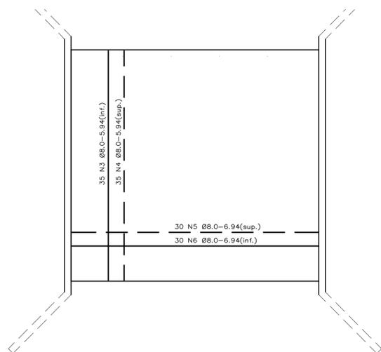
PLANTA DE ARMAÇÃO SUPERIOR E INFERIOR DAS LAJES
