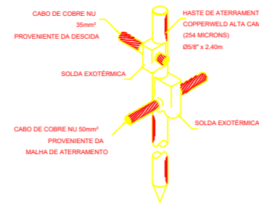
7 DET. - HASTE DE ATERRAMENTO SEM ESCALA
