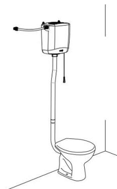
A fixação das bacias e das caixas de descarga deverão ser feitas conforme recomendações do fabricante, devendo ser adotado o anel de vedação, bolsas e demais acessórios de instalação.
